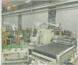
Pressenautomatisierung: Zuschnitt von SMC-Halbzugmaterial mit anschließender Gewichtskontrolle.
