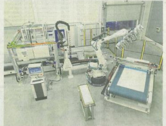
Automatisierte Anlage zum Schneiden, Stapeln und Vorformen von trockenen Fasern im Technology-Lab in Bruchsal. Fotos: Schmidt & Heinzmann GmbH & Co. KG
